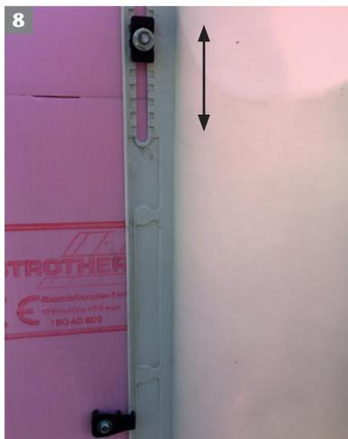
8 Durch Anheben und einer 90 Grad Drehung wird der Rastblock in die Schiebeposition befördert. Nun kann der komplette Lichtschachtkörper in der Höhe verschoben werden.
