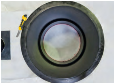
Anzeichnen des Innendurchmessers
