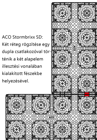
ACO Stormbrixx SD: Két csatlakozó egymásba illesztése adja a rögzítési pontot a két réteg között.
