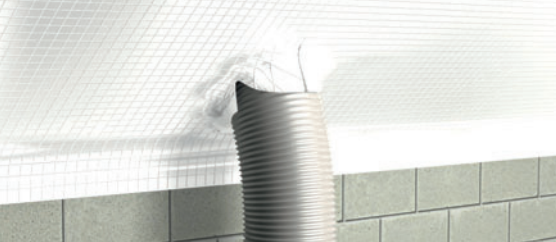
DELTA® légzáró és párafékező fólia csomópontához illesztése.
